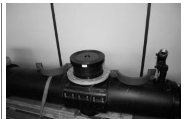
Ábra 55. - Záródugó tartó eltávolítása
