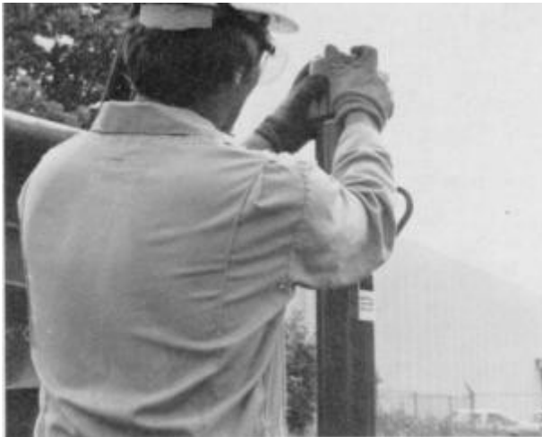
Ábra 25. Forgassa a csavarorsó beállító védősapkát
