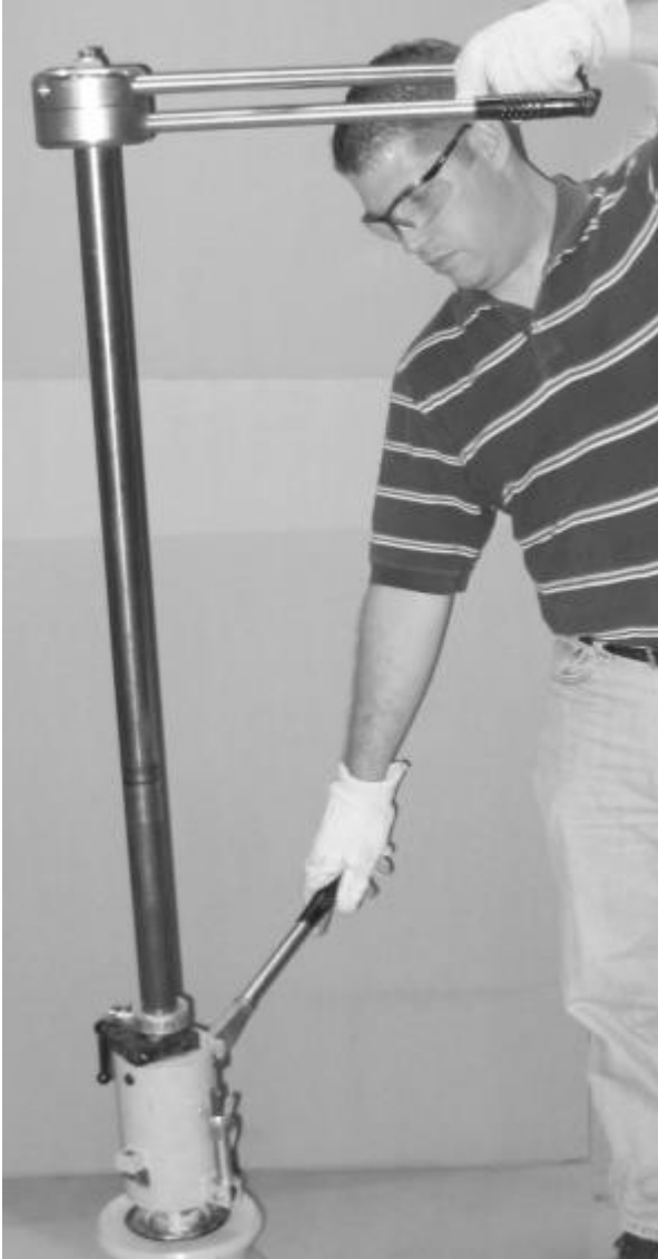
Ábra 41. Az elzáró fej leeresztése
