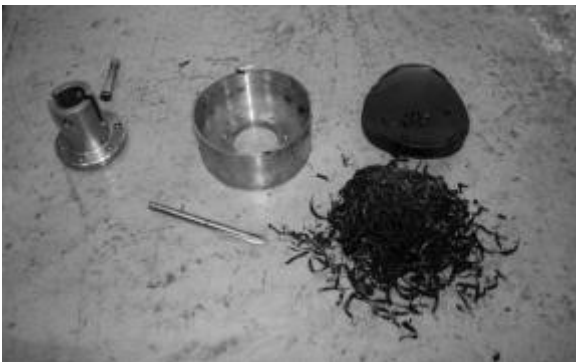
Ábra 27. Távolítsa el a forgácsot és a pogácsát
