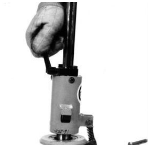
Ábra 45. Húzza meg a vezérlőrúd rögzítőjét
