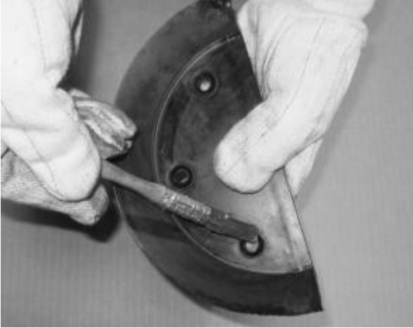
Ábra 32. Kenje meg a zárógumit
