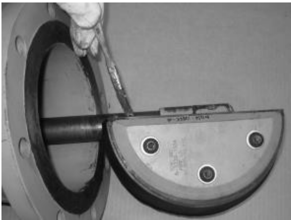
Ábra 36. Kenje meg a zárógumikat
