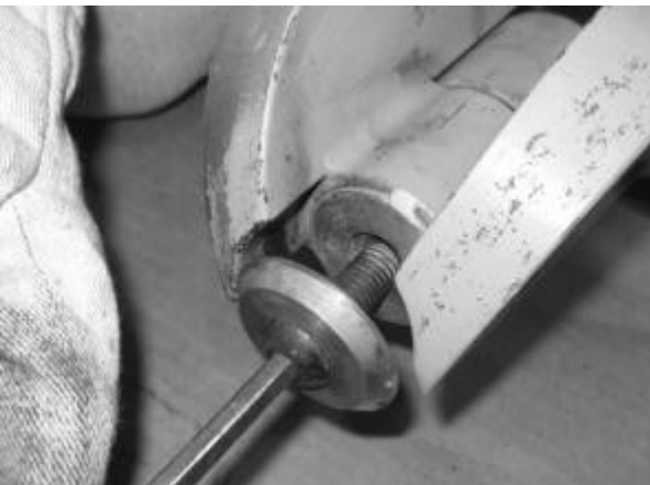
Ábra 31. Rögzítse az elzáró fejet
