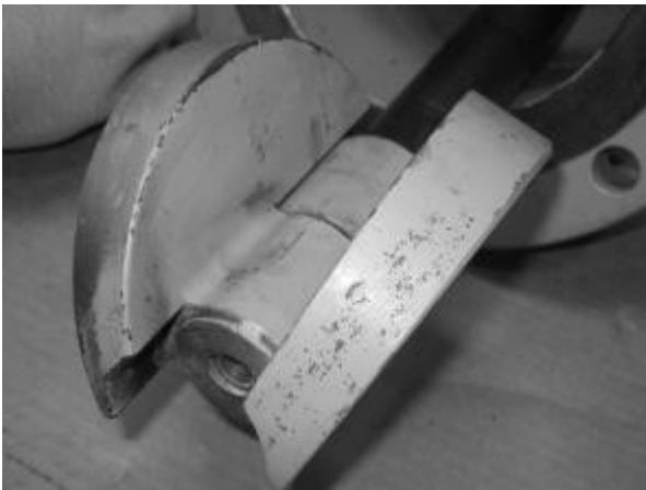
Ábra 30. Szerelje fel az elzáró fejet majd rögzítse
